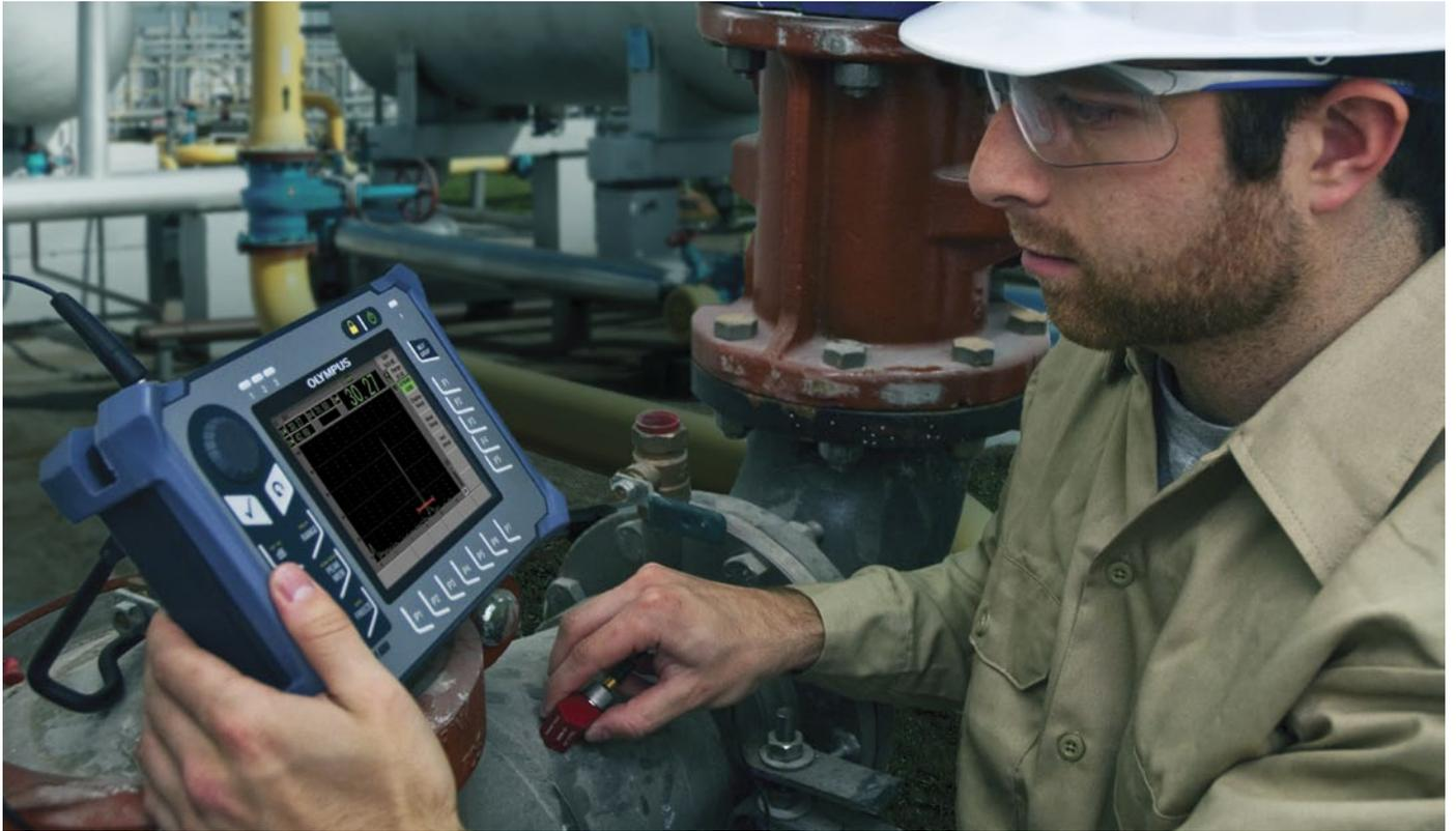
EPOCH 600数字式超声探伤仪将Olympus领先行业的常规探伤性能及仪器机身小巧、操作直观的高效性融合在一起。该款探伤仪使用高效的菜单功能和快捷键访问参数，为检测人员提供了操作极为简便的高质量的缺陷检测平台。
