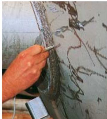
图2: 测量焊缝处的铁素体含量
