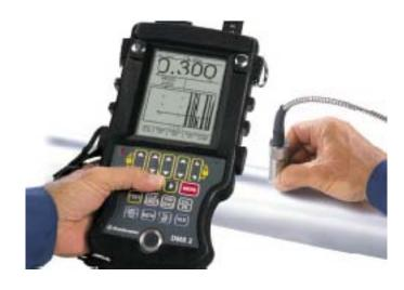
DMS 2适用于要求非常高的腐蚀测量。配置的数据记录器能将 大量的厚度数据载入电脑并保存分析。
