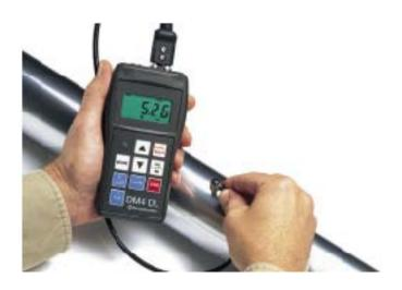
DM 4系列侧厚仪能完成大部分应用要求,特别适用于腐蚀管壁 残余壁厚的测量。
